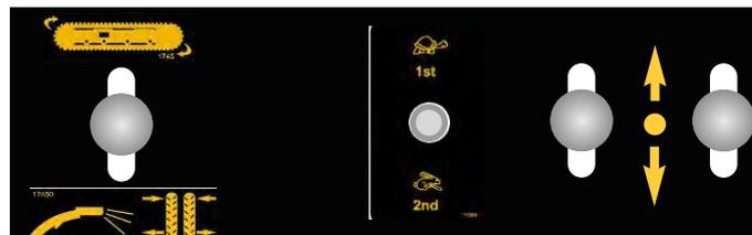
Die Anpassung der Kettenbreite ist nur möglich, wenn sich die Ketten-/Häckselsteuerung in der Häckselposition befindet. Der Griff zur Kettenanpassung ist zur Mitte gefedert (siehe Diagramm auf der rechten Seite). Je mehr Sie den Griff bewegen, desto mehr werden die Ketten angepasst. Um die Ketten nach außen zu bewegen, bewegen Sie den Griff zur Kettenanpassung nach *oben*. Um die Ketten nach innen zu bewegen, bewegen Sie den Griff zur Kettenanpassung nach *unten*.
