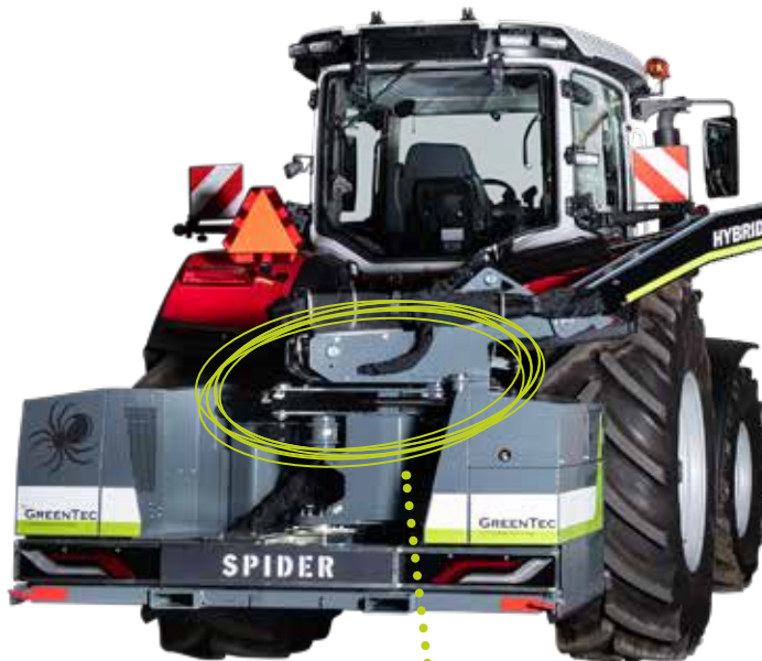
Dreheinheit: Die Dreheinheit kann um 180° von rechts nach links bewegt werden. Sowohl die Seitendreh-Einheit als auch die Schwenkfunktion des Arms sind in beide Richtungen kollisionsgeschützt.
