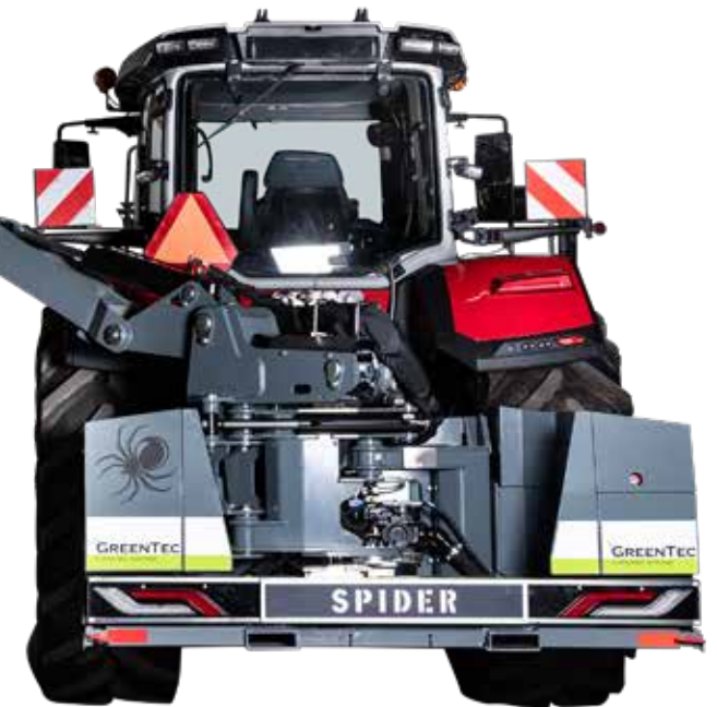
Von der Kabine aus wird der Arm von rechts nach links und nach vorn in das Sichtfeld des Fahrers bewegt.
