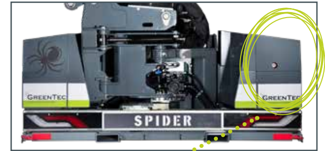
Der 220-Liter-Hydrauliktank befindet sich auf der rechten Seite, während die Hydraulikventile und der Ölkühler auf der linken Seite sitzen.
