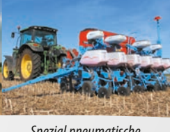
Spezial pneumatische Einzelkornsämaschine Monoshox NX M für « Minimalbodenbearbeitung » mit Doppelsätscheiben
