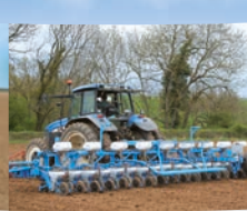
Mechanische Einzelkornsämaschine Typ MECA V4 für Zuckerrüben
