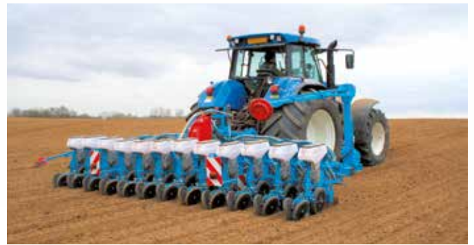
12-reihige, klappbare Doppelbalken-Sämaschine (45 cm Reihenabstand)
