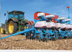
Spezial pneumatische Einzelkornsämaschine Monoshox NX M für « Minimalbodenbearbeitung » mit Doppelscheiben
