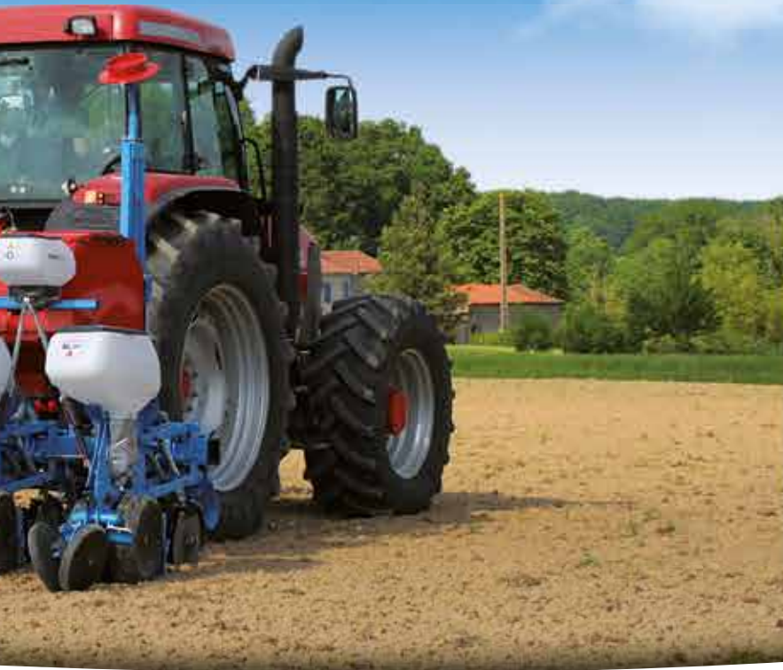
6-reihige, einfache Monoblock-Sämaschine mit Teleskoprahmen (75 cm Reihenabstand).
