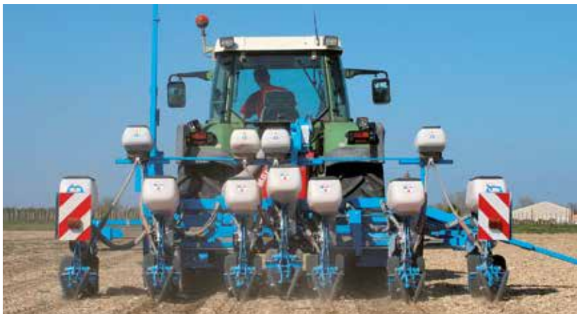
Die 6/7-reihige Extend-Ausführung erlaubt in 6-reihiger Version Reihenabstände von 75 und 80 cm und in 7-reihiger Version Reihenabstände von 55 und 60 cm. Sie erlaubt auch ohne Abbau von 6 Reihen Mais auf 7 Reihen Raps/Sonnenblumen zu wechseln.
