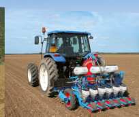
Spezial Gemüsesämaschine Typ MS für Feinsaat
