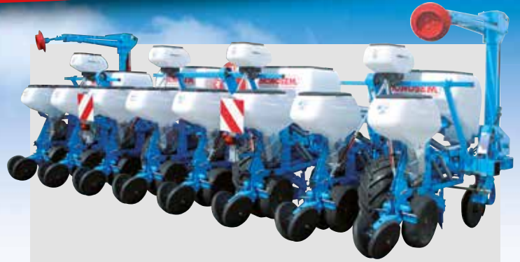
8-reihige, klappbare Doppelbalken-Sämaschine (75 cm Reihenabstand)
