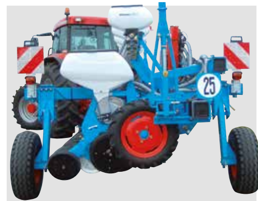
Für überbreite Sämaschinen ist ein mechanisch-oder hydraulisch-bedienbarer Längstransportwagen verfügbar.
