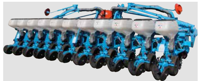
11-reihige klappbare Sämaschine TFC2 Comfort (55 cm Reihenabstand)
