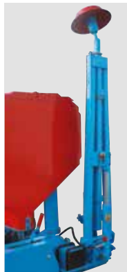
Hydraulische Spuranzeiger sind serienmäßig auf allen Sämaschinen.
