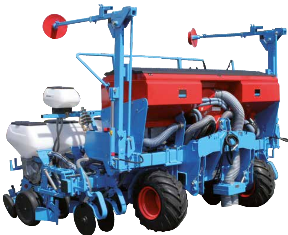
6-reihige Monoblock2 Komfort Sämaschine mit 680 L Düngerstreuer und Microsem
