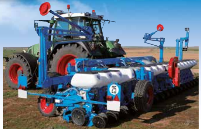
18-reihige, gekuppelte Sämaschine (45 cm Reihenabstand).
