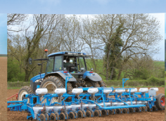
Mechanische Einzelkornsämaschine Typ MECA V4 für Zuckerrüben
