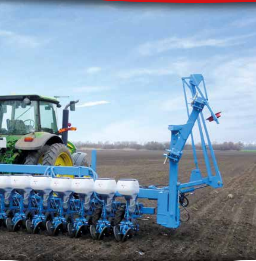
18-reihige, gekuppelte Sämaschine (45 cm Reihenabstand).
