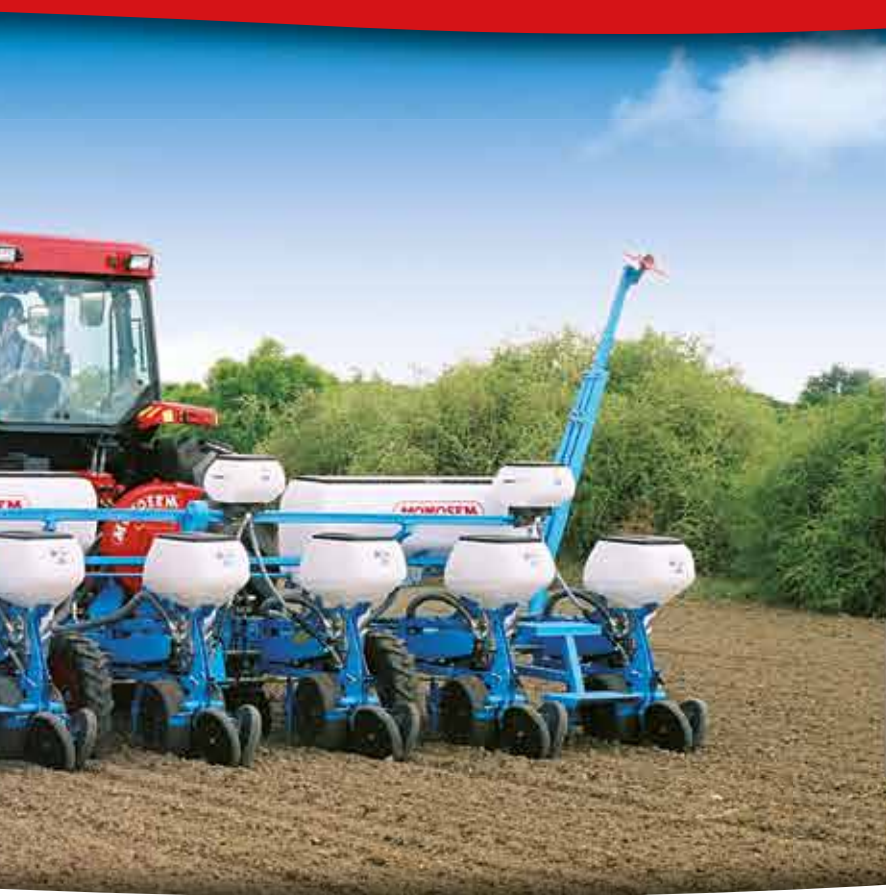
Starre 4-reihige, Monobar-Sämaschine (75 cm Reihenabstand).
