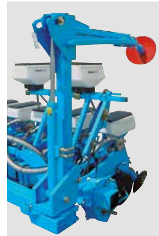
12-reihige, klappbare Doppelbalken-Sämaschine (45 cm Reihenabstand)
