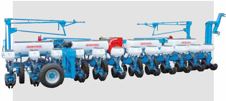
12-reihige, gekuppelte Sämaschine (75 cm Reihenabstand).
