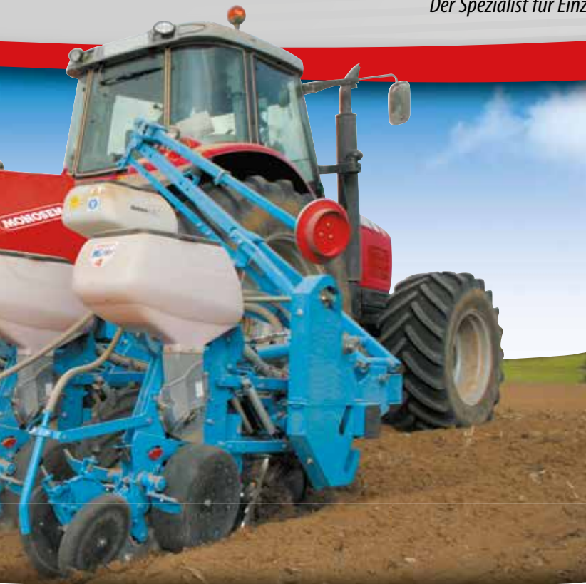
8-reihige, klappbare Sämaschine mit freilaufendem TFC Rahmen (75 cm Reihenabstand)
