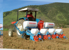
Pneumatische Einzelkornsämaschine Typ NC mit Schar
