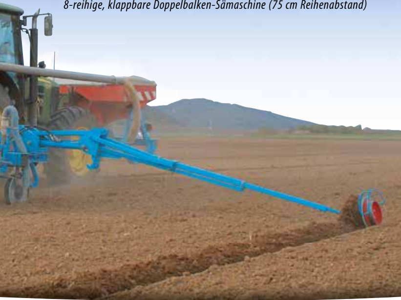
8-reihige, klappbare Doppelbalken-Sämaschine (75 cm Reihenabstand)
