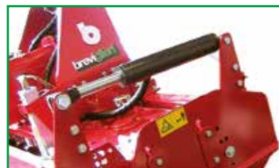
OPTION Hydraulic jacks (2) I Martinetti idraulico (2) F Vérins hydraulique (2) D Hydraulische Zylinder (2) E Cilindro hidráulico (2)
