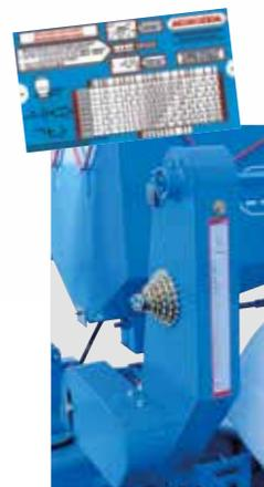
Die Einstellung der Microsem-Granulatstreuer erfolgt über ein 18-gängiges Wechselradgetriebe. Für Sonderausbringungen sind noch weitere Zahnräder sowie eine Schnellauskupplung verfügbar. Der mit dem Microsem gelieferte Einstellstab erlaubt eine schnelle Einstellung der Aussaatmengen.
