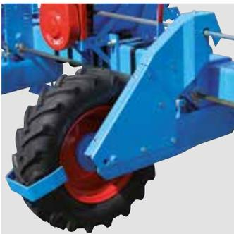
Das Getriebe der Monoshox NX M-Einzelkornsämaschinen ist mit Schutzhauben versehen. So wird bei Begrünung oder Pflanzenrückständen ein lückenloser Einsatz gewährleistet.
