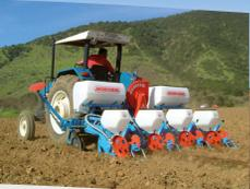
Pneumatische Einzelkornsämaschine Typ NC mit Schar
