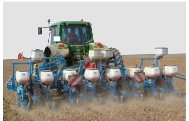
8-reihige klappbare Einzelkornsämaschine (Reihenabstand 80 cm)
