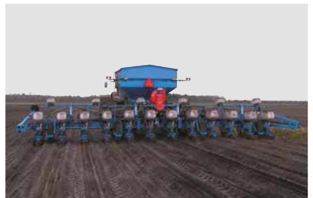
12-reihige klappbare Einzelkornsämaschine (Reihenabstand 75 cm)
