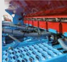
Die WingFold-Sämaschinen verfügen über einen 1030 Liter (6 Reihen) und 1500 Liter (8 Reihen) Düngerstreuer mit individuell durch Schieber schließbare Edelstahllosierungen. Eine Doppelfunktionsturbine (Df) sorgt für ein effizientes Aufsaugen des Samens und für den sicheren Transport des Düngemittels bis zu den äußeren Reihen. Eine Treppe sichert den einfachen Zugang zum Düngerbehälter.
