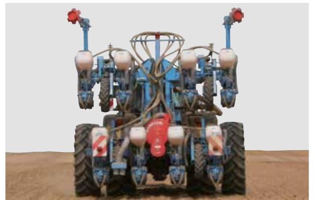
8-reihige Einzelkornsämaschine (In Transportstellung klappbar)
