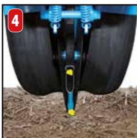
4 Das gekrümmte Saathöhle\* wurde speziell geformt, um die Körner sanft und mit hoher Genauigkeit in den Boden zu legen.
