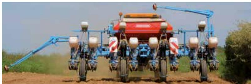
Die 8-reihige, gezogene klappbare WingFold-Sämaschine verfügt über hydraulische Stützräderblöcke, die einen optimalen Bodenabstand sowie hohe Stabilität am Vorgewende gewährleisten.
