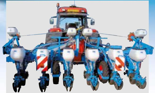
6-reihige klappbare Einzelkornsämaschine (Reihenabstand 75 cm)
