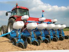
Pneumatische vielseitige Einzelkornsämaschine Typ NG Plus 4 mit Doppelscheiben
