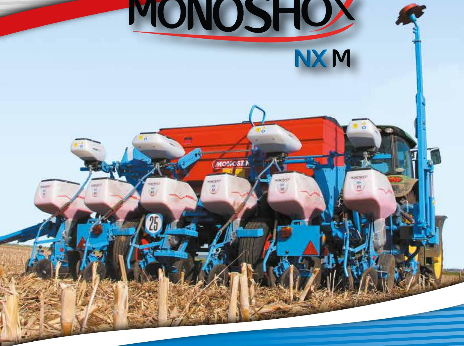
*Pneumatisches Sägerät mit Doppelscheiben*
