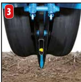
3 Die Doppelscheiben öffnen die Furche auf einer durch die Druckrollen bestimmten Tiefe. Die Scharspitze bereitet den Furchenboden zur optimalen Saatkornablage.
