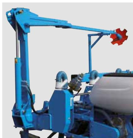
Doppelklappbare Spuranzeiger für bis zu 12-reihige Sämaschine
