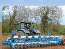
Mechanische Einzelkornsämaschine Typ MECA V4 für Zuckerrüben
