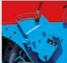
Das FertiDrive<sup>VM</sup> Variogetriebe erlaubt eine sehr einfache und schnelle Einstellung der gewünschten Düngemittel-Ausbringung pro Hektar. Dieses Getriebe kann ebenso schnell ausgekuppelt werden, um den Düngemittelbeitrag an Orten, wo er nicht benötigt wird, abzuschalten.
