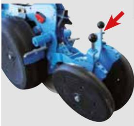
Der Anpressdruck der PRO-Zwischenandruckrolle ist einstellbar. Er ist mit der Druckregelung des hinteren Anpressblockes kombiniert.
