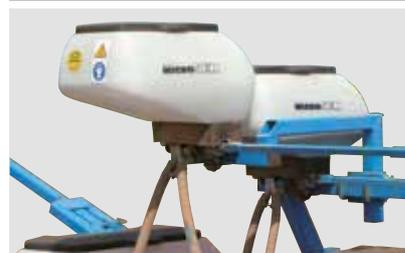
Die Microsem für Insektizide und die Microsem für Schneckenkorn können für die gleichzeitige Ausbringung der 2 Produkte verbunden werden.
