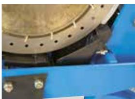
Die Zellen der Aussaatüberwachung sind unter den Gehäusen der Elemente angeordnet. Ein Lichtstrahl erlaubt, den Durchgang der Saatkörner zu kontrollieren, sogar die kleinsten.
