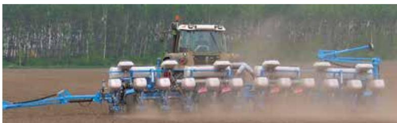
Gezogene 12-reihige WingFold Flex-Sämaschine mit Düngerstreuer (76,2 cm Reihenabstand)
