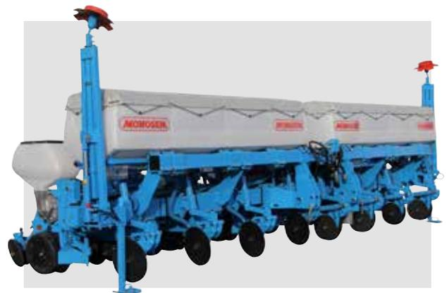
8-reihige, Sämaschine mit Düngestreuer (75 cm Reihenabstand)
