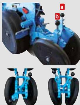
Das Monoshox NX M Säelement ist mit hinteren V-Andruckrollen mit Schnellverstellung ausgerüstet. Mit dem rechten Hebel (a) kann der Bodendruck der hinteren V-Andruckrollen schnell und genau eingestellt werden. Mit dem linken Hebel (b) kann der Winkel der V-Andruckrollen schnell an die Aussaatbedingungen angepasst werden.
