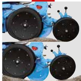
Die Pro-Andruckrolle passt sich unabhängig der Tiefenkornablage oder des hinteren Andruckrollen Aggregats perfekt dem Boden für einen regelmäßigen Körnerandruck an.
