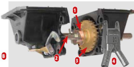
Die „Schneckenkorn“ Schrauben (B) erlauben eine Dosierung von 3 bis 10 kg/ha bei 75 cm Reihenabstand.
