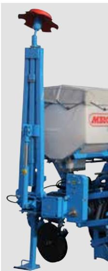
Spuranzeiger für 6- und 8-reihige Sämaschinen
