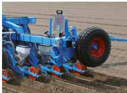
Für die sehr breiten Sämaschinen ist ein Längstransportwagen verfügbar. Die Räder des Transportwagens werden manuell oder hydraulisch angehoben.
