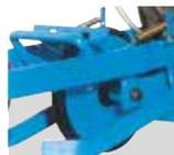
Zwischenanpressrolle mit flexiblem, Zweireihiges Einbringungsschar selbstreinigendem Überzug
