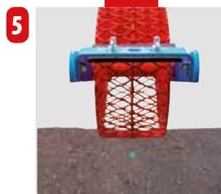
5) Das hintere Stützrad schließt die Furche, presst den Boden um die Körner und sichert eine optimale Keimung.
