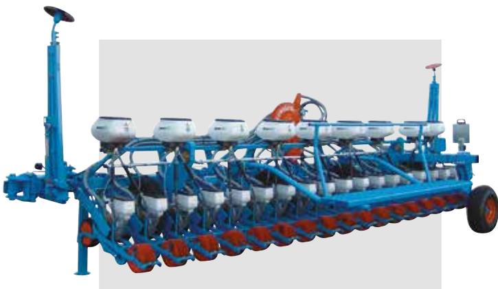
MS A-Sämaschine - Starr Doppelbalken - 18 Reihen
