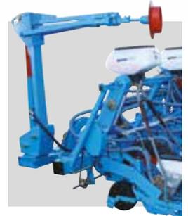
Hydraulisch klappbarer Spuranzeiger mit Scheibensech für klappbare Rahmen (verschiedene Modelle je nach Rahmen)
