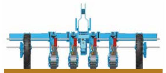
Die Höheneinstellbaren Räderblöcke erlauben, die Sämaschine auf Flachland sowie auf Beeten einzusetzen.
