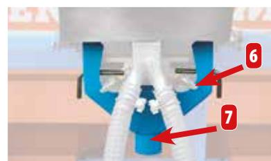
Der Microsem Behälterinhalt beträgt 20 Liter. Die Entleerungsklappen (6) und die Entleerungsrutsche (7) erlauben ein einfaches und schnelles Entleeren der Behälter.
