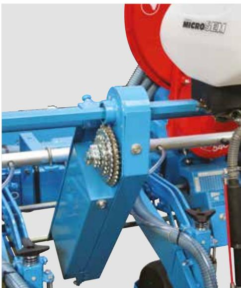
Die Einstellung der Microsem-Granulatstreuer erfolgt über ein 3-stufiges Wechselradgetriebe. Dieses 40-gängige Getriebe ist so für alle üblichen Bedürfnisse geeignet.
