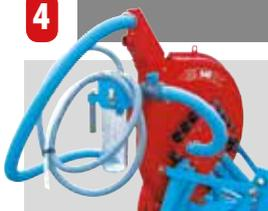
Die MS-Sämaschinen sind serienmäßig mit einem Samensauger ausgestattet. So können die übrigen Samenreste einfach und schnell aus dem Samenbehälter zurück in einen durchsichtigen Behälter gesaugt werden.
