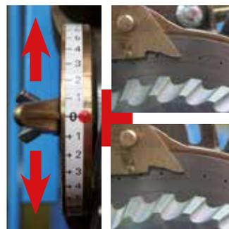
Die Einstellung der Dosierung erfolgt über einen einzigen, leicht zugänglichen Schalthebel, der oben auf den Gehäusen angeordnet ist. Die Qualität und die Präzision der MS Dosierung erlauben eine gleichmäßige Einstellung von allen Elementen.
