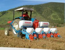
Pneumatische Einzelkornsämaschine Typ NC mit Schar
