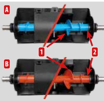
Die Verteilung per Förderschnecke (1), verbunden mit einem Rührwerk (2), gewährleistet eine regelmäßige Dosierung des Düngemittels.
