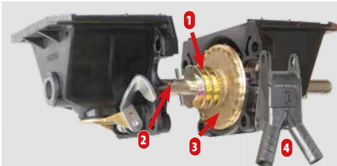
Die Microsem-Ausbringung basiert auf einem Förderschneckensystem. Die im Behälter enthaltenen Mikrogranulate werden durch zwei Förderschnecken (1) übernommen. Die Rührwerke (2) sichern eine gleichmäßige Zufuhr zu den Förderschnecken. Ein Fingerrad (3) verteilt dann gleichmäßig das Produkt in den Rutschen (4).
