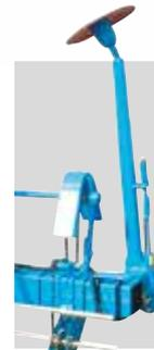
Hydraulisch klappbarer Spuranzeiger (auch mit Scharen erhältlich)
