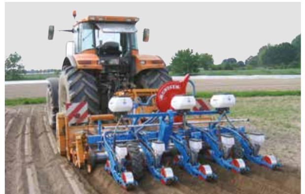
MS A-Sämaschine - Starr Einzelbalken - 5-reihig mit Microsem
