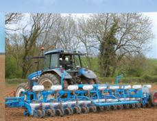
Mechanische Einzelkornsämaschine Typ MECA V4 für Zuckerrüben
