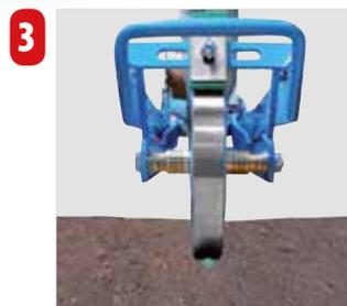
3) Die druckeinstellbare Zwischenanpressrolle presst die Körner an den Boden und gewährleistet somit eine optimale und regelmäßige Keimung.
