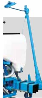
Manuell klappbarer Spuranzeiger mit Scharen
