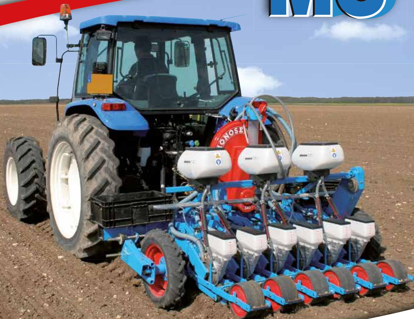
*Pneumatisches Sägerät für Gemüsebau*
