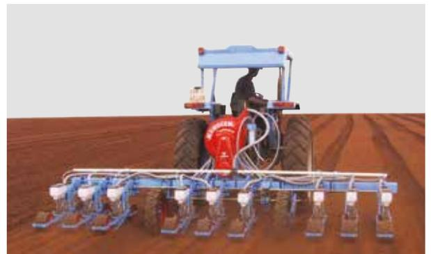
MS A-Sämaschine - Starr Einzelbalken - 3 x 3-reihig
