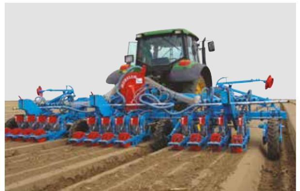
MS C-Sämaschine - Einzelbalken, kompakt, klappbar 3 x 4 Doppel-Reihen
