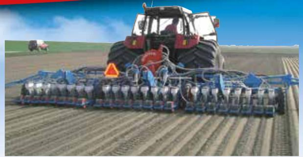
MS A-Sämaschine - Doppelbalken, klappbar - 3 x 8 Reihen
