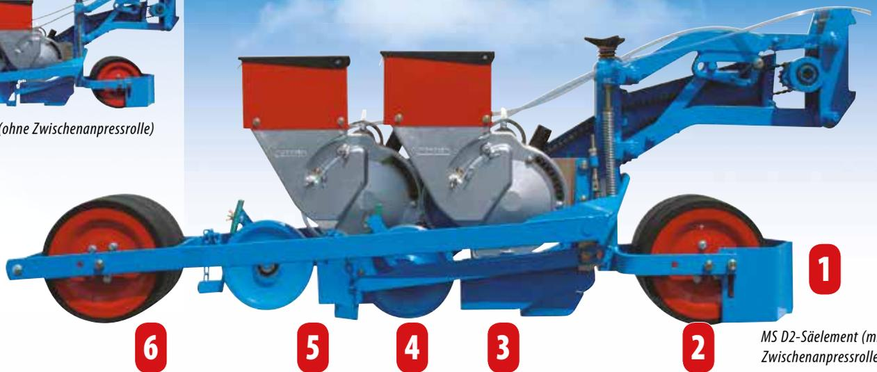
MS D2-Säelement (mit Zwischenanpressrolle)
