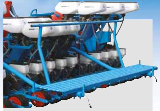
Ein Zugangstreppe zur Aussaatkontrolle ist optional für die MS-Sämaschinen verfügbar. Diese 2,70 m breite Zugangstreppe ist mit einem Sicherheitsgeländer ausgestattet.
