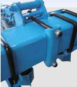
Das Befestigungssystem der Dosiereinheit durch Bügel erlaubt deren sichere und solide Befestigung. Bei Bedarf können die Dosiereinheiten durch Lockern der Bügel verschoben werden, um den Reihenabstand zu verändern. Dieses Befestigungsprinzip schließt, auch im Einsatz, jede seitliche Verschiebung des Elementes aus.
