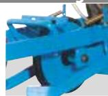
Zwischenanpressrolle mit flexiblem, selbstreinigendem Überzug
